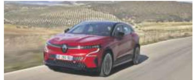
für Elektromobilität vorantreibt. Renault bietet das Elektromodell in zwei Leistungsstufen mit 96 kW/131 PS und 160 kW/218 PS an. Auch die Batterie ist in zwei Kapazitätsstufen verfügbar: mit 40 kWh und mit 60 kWh. Die Akkus lassen sich mit einer breiten Spanne von Ladeleistungen und Stromstärken „betanken“, darunter je nach Version auch an Gleichstrom-Schnellladestationen mit bis zu 130 kW.
