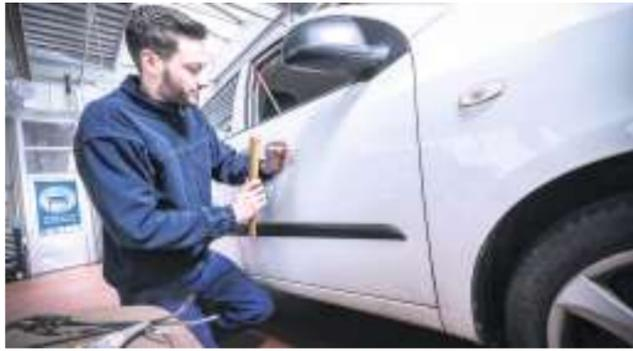
Leichte Beschädigungen lassen sich mit Smart-Repair-Methoden beheben.
