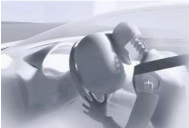
Nach 30 Millisekunden ist der Airbag prall aufgeblasen und kann die Insassen schützen. Foto: djd/Bosch
