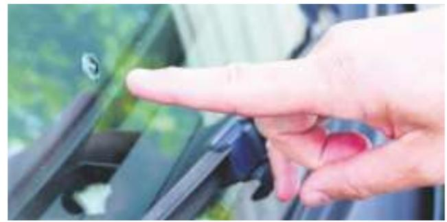
Vollkasko abgedeckt.“ Reparieren ist möglich, wenn der Steinschlag kleiner als eine Zwei-Euro-Münze ist, sich mindestens zehn Zentimeter vom Rand der Windschutzscheibe entfernt befindet und nicht im unmittelbaren Sichtfeld des Fahrers liegt. Wichtig für eine erfolgreiche Reparatur ist auch, den Schaden gegen Schutz und Feuchtigkeit abzusichern. Dafür zuerst die beschädigte Stelle vorsichtig säubern,
