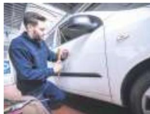
Leichte Beschädigungen lassen sich mit Smart-Repair-Methoden beheben. Fotos: ProMotor/Timo Volz
